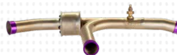
SYSTÈME RÉSERVOIR ET ÉJECTION FUEL CHALLENGER 350 - BOMBARDIER
